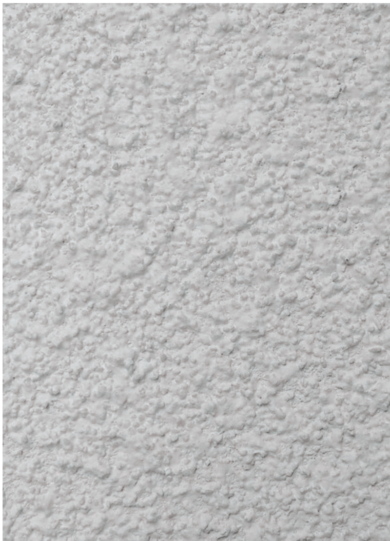
Putsstruktur 13. Organisk sprutad ytputs, kornmax 1,5 mm
