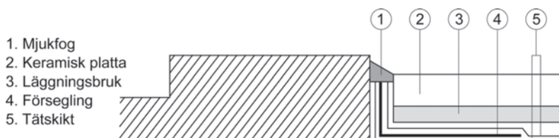
Figur MBE.1212/1. Anslutning av tätskikt mot tröskel.
