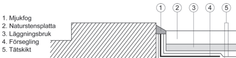
Figur MBB.1212/1. Anslutning av tätskikt mot tröskel.
