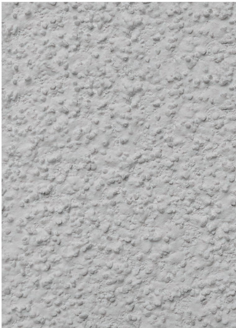
Putsstruktur 14. Organisk sprutad yputs, kornmax 2 mm
